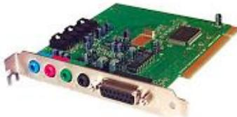
Sound card (kartu suara) adalah perangkat yang terhubung pada papan induk (*motherboard*) yang berfungsi sebagai alat untuk mengolah dan mengontrol suara, baik suara yang masuk (merekam) dan suara yang keluar melalui speaker. Hal ini dimungkinkan karena pada *sound card*
