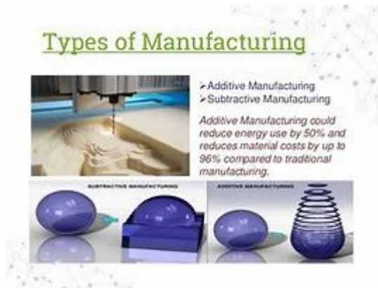
*Additive manufacturing* merupakan terobosan baru di industri manufaktur yang sering dikenal menggunakan printer 3D. Dalam era digital saat ini, gambar desain digital yang telah dibuat dapat diwujudkan menjadi benda nyata dengan ukuran dan bentuk yang sama dengan desain sebenarnya atau dengan skala tertentu.
