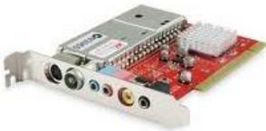
TV Tuner merupakan perangkat yang memungkinkan komputer untuk menangkap siaran televisi dan menampilkan-kannya pada layar monitor. TV Tuner biasanya berupa kartu (*card*) yang dipasang pada card ekspansi. Tapi ada juga TV Tuner External yang dipasang di luar komputer, bahkan bisa langsung dihubungkan ke monitor.
