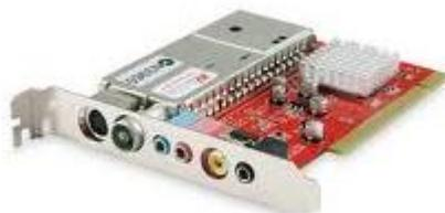
TV Tuner merupakan perangkat yang memungkinkan komputer untuk menangkap siaran televisi dan menampilkannya pada layar monitor. TV Tuner biasanya berupa kartu (*card*) yang dipasang pada card ekspansi. Tapi ada juga TV Tuner External yang dipasang di luar komputer, bahkan bisa langsung dihubungkan ke monitor.
